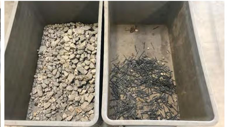
Abb. 4 bis Abb. 6: Sortierung von carbonbetonhaltigen Bruchmaterialien bzw. sekundären Wertstoffen
