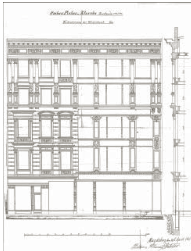
Fassadenzeichnung des Hauses Breiter Weg 142/ 143 zum Umbau 1891
