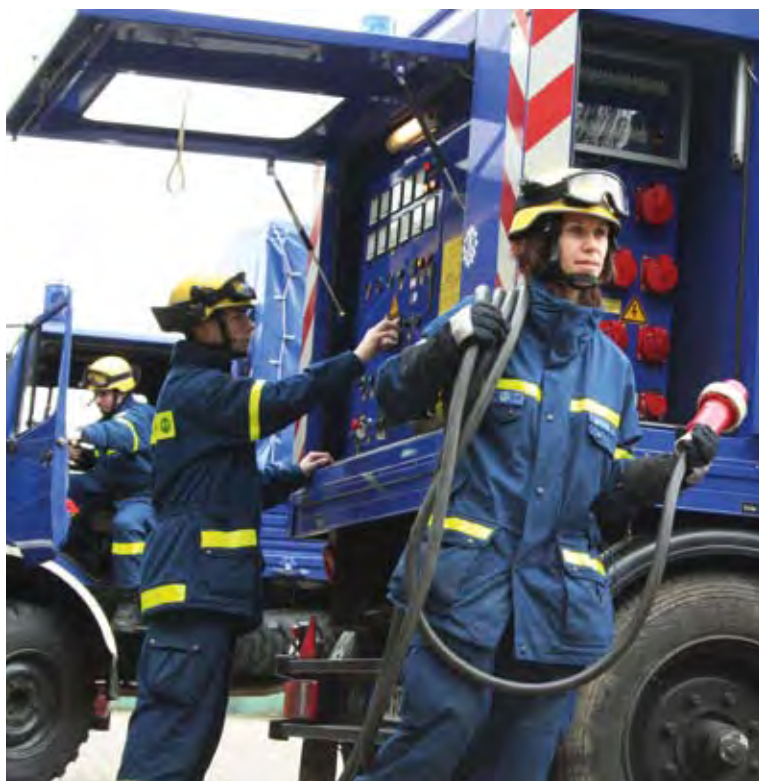
Abbildung 29, 30, 31: Einsatz von Netzersatzanlagen (NEA) zur Notstromversorgung
