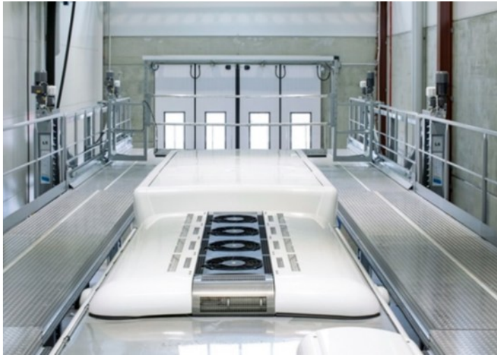
Abb. 73: Dacharbeitsstand (Blick von oberer Ebene auf Fahrzeugdach)
