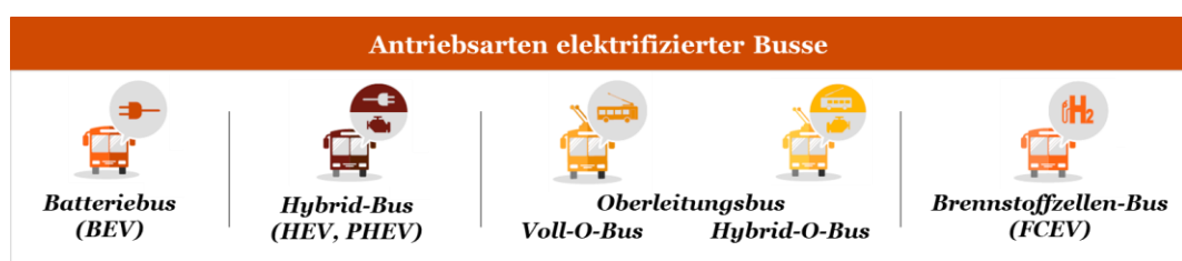
Abb. 3: Antriebsarten elektrifizierter Busse im ÖPNV
