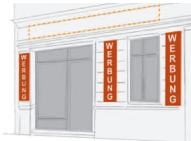
Es sind zu viele Schilder, die sich zudem außerhalb des zulässigen Bereichs für Flachwerbung befinden.
