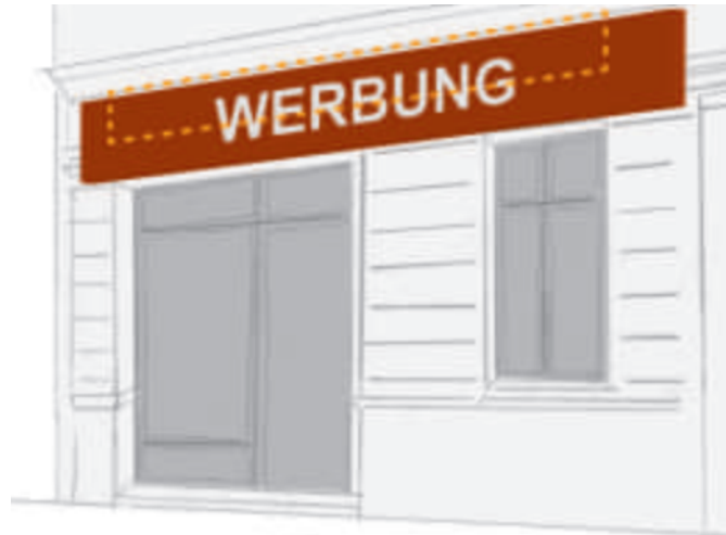
Das Schild ist zu groß und überdeckt Gestaltungselemente der Fassade.
