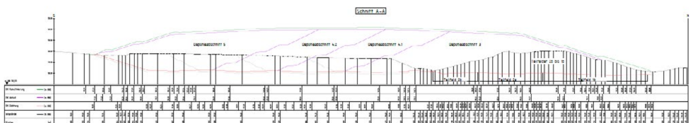
Abb. 44: Schnitt durch den Deponiekörper mit Darstellung der geplanten Deponieabschnitte
