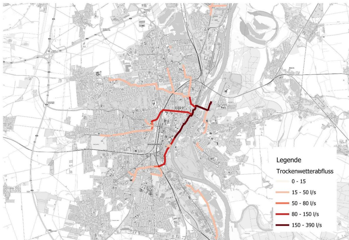
Abbildung 36: Größere Abwasserkanäle mit Trockenwetterabfluss
