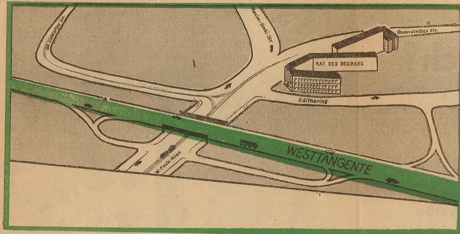
So wird der Verkehrsknotenpunkt am Damaskheplatz gestaltet werden. Auffahrt- und Abfahrtrampen sichern den niveaufreien Anschluß der Westtangente an das vorhandene Straßennetz.
