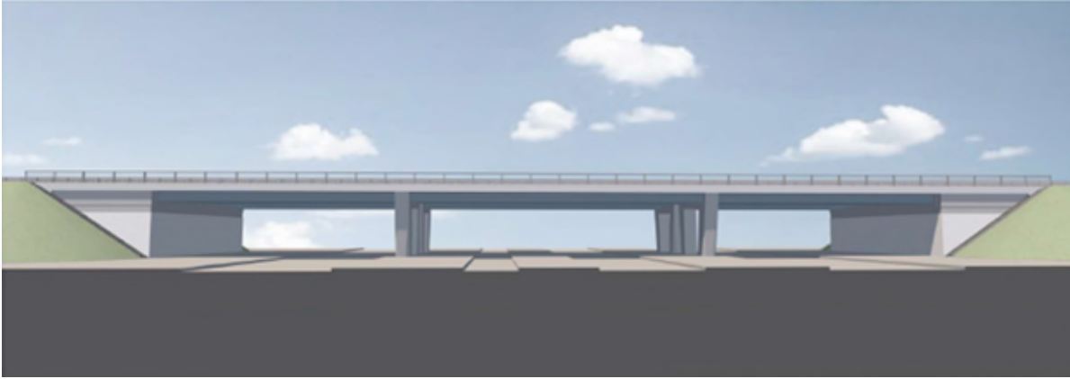
Ansicht Vorzugsvariante: Verbundfertigteilträger parallelgurtig, semiintegral, Querträger aus Stahlbeton
