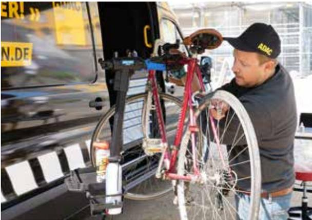
relevanten Bauteile an und haben u.a. Bremsen, Beleuchtung, Lenkung, Pedale und den Antrieb – Motor, Kette und Schaltung – im Blick. Kleinere Fehler beheben sie sofort. Ansonsten erhalten Fahrradfahrende eine Checkliste mit Empfehlungen für die Werkstatt. Außerdem stellen unsere ADAC Techniker Lenker und Sattelhöhe passend zur Körpergröße ein.
