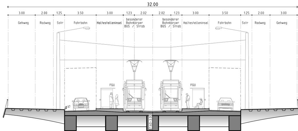
REGELQUERSCHNITT ALTE ELBE - VARIANTE 0\*
