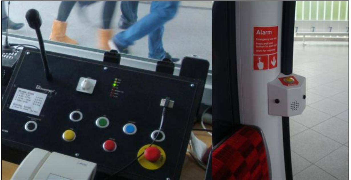
Abbildung 32: Einsprechstelle im Kommandostand / Gegensprechstelle in einer Kabine, Quelle: IB Schweiger.
