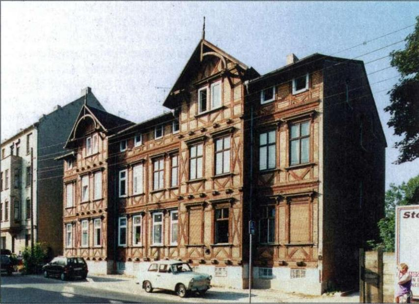
Abb. 165 Cracau, Potsdamer Str. 8a, Zustand 1994, Schaden im Giebel; Sokkelfachwerk abgerissen und Verunstaltung der Fassade durch Kunststofffenster
