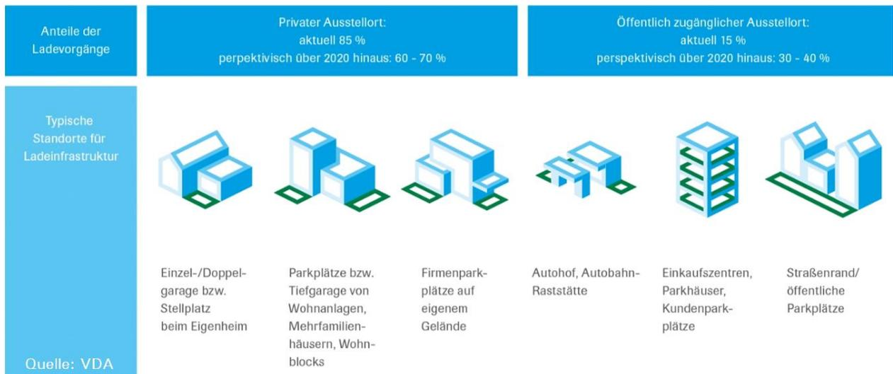
Abb. 7 Standorte für Ladeinfrastruktur und zu erwartende Anteile von Ladevorgängen (Quelle: VDA, Verband der Automobilindustrie)
