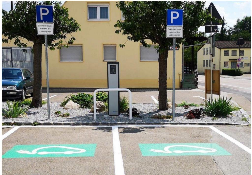
Abb. 43 Negativbeispiel: Ladesäule auf unbefestigter Oberfläche (Schotter), Bildquelle: Markt Manching
