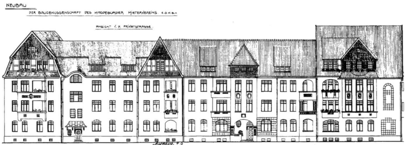
Abb. 220 Fassaden am Goetheweg: Alexander-Puschkin-Straße 29, Goethestraße 35, Bau D und E, die Loggien an der rechten Seite des mittleren Bauteils sind in der Ausführung geschlossen
