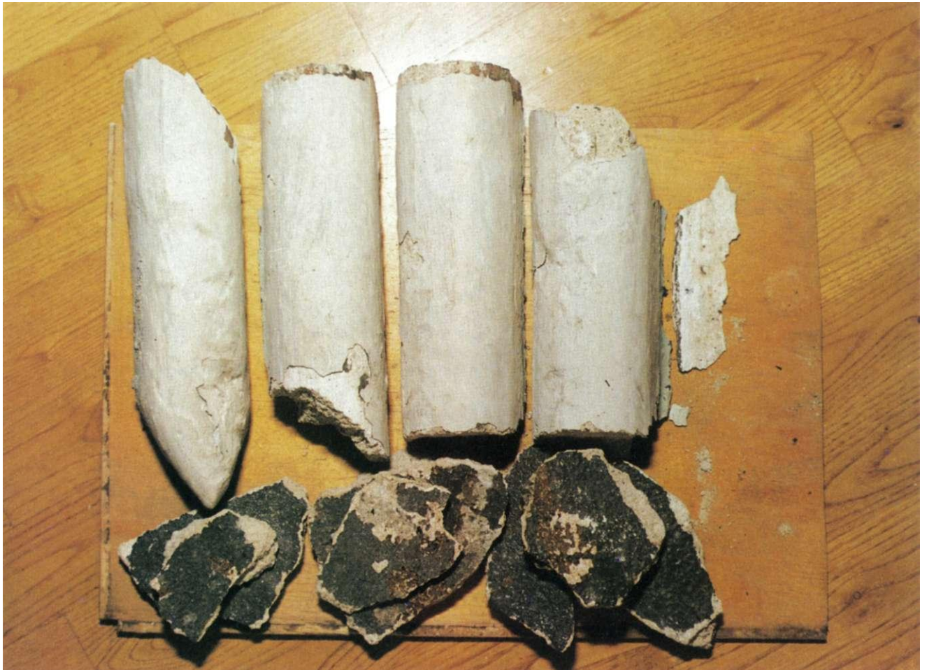
Abb. 132 Sternstraße 29 a Bausubstanz aus dem Eingangsbereich. Der letzte, rechte Rundstab an der Nordwand und ein Teil der Putzfläche im Sockelbereich mußten wegen des hohen Zerstörungsgrades abgenommen werden. Somit konnten die Trägermaterialien mit der Fassung konserviert und an den Objekten weiterreichende Untersuchungen vorgenommen werden. Unter Zuhilfenahme des Mikroskopes ergaben sich Aussagen zur Farbigkeit und zum Ornament. Die Bausubstanz ist anschließend archiviert worden und kann bei Bedarf jederzeit eingesehen werden.
