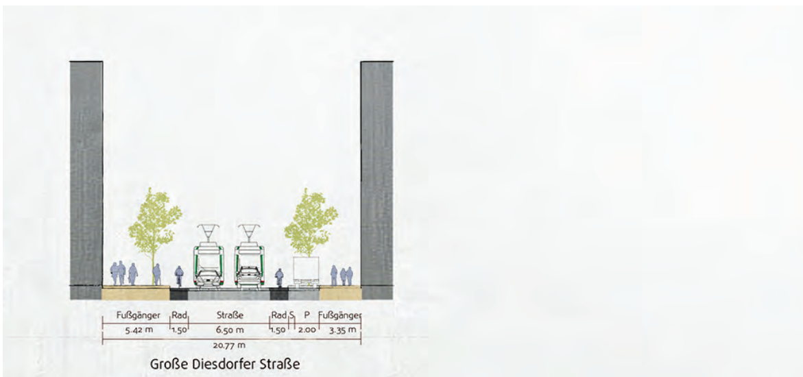
Abbildung 146: Querschnitt A-A Variante 3 auf Höhe Haltestelle Arndtstraße
