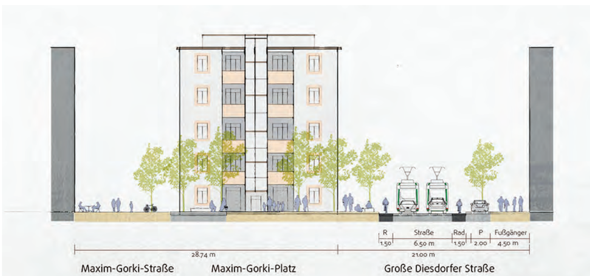
Abbildung 144: Querschnitt B-B Variante 2 auf Höhe Maxim-Gorki-Straße
