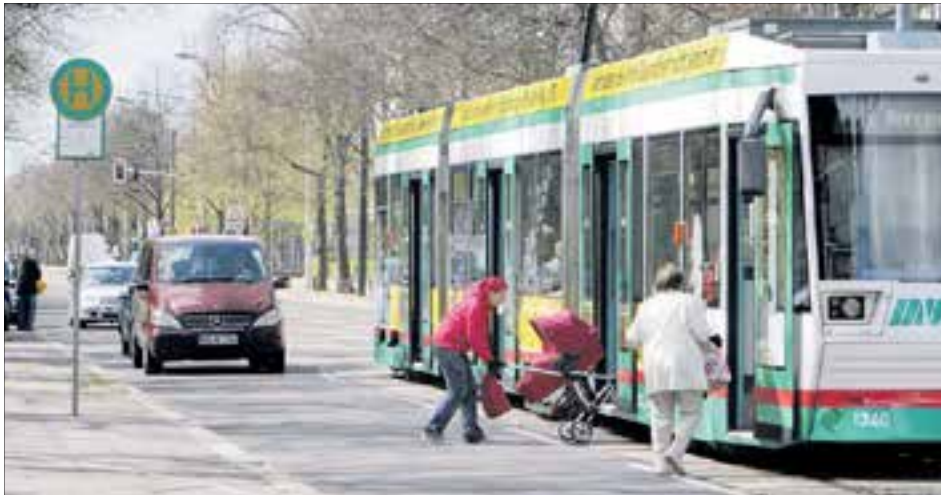
Achtung Kippgefahr: Eine Frau mit Kinderwagen meistert die Hürde zwischen ebener Erde und Bahnkante beim Einstieg an der Straßenbahnhaltestelle Westfriedhof in der Großen Diesdorfer Straße. Rollstuhlfahrer haben keine Chance. Und auch gehbehinderte und alte Menschen tun sich schwer mit der mangelhaften Barrierefreiheit an MVB-Haltestellen zum Beispiel entlang dieser Magistrale. Ein SPD-Antrag zur Abhilfe wurde dennoch höchst kontrovers diskutiert. Foto: Viktoria Kühne
