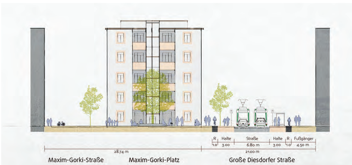
Abbildung 147: Querschnitt B-B Variante 3 auf Höhe Maxim-Gorki-Straße
