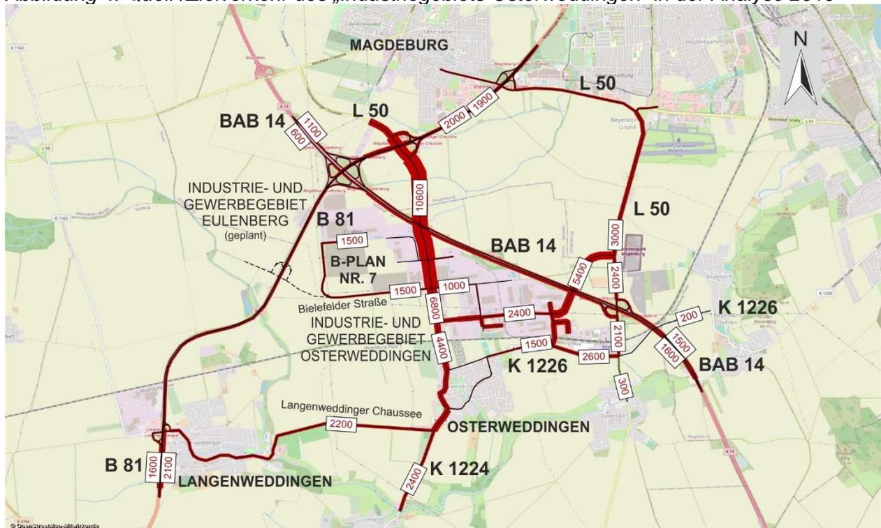
Im Abgleich der Modellbelastungen ergeben sich Differenzen zu den Zählergebnissen von bis zu maximal 10 %, so dass das Ergebnis als plausibel gewertet werden kann.
